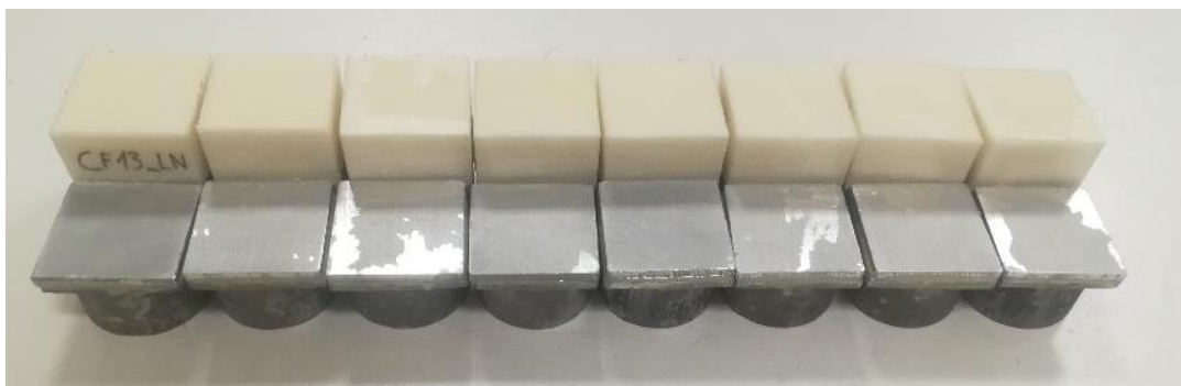
3. att. Parauga CF13 adhēzija uz alumīnija virsmas pēc kriošoka
