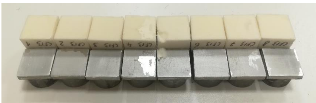
2. att. Parauga CF13 adhēzija uz alumīnija virsmas pirms kriošoka
