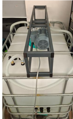
600 L polimērmateriāla bioreaktora trauks ar uzstādītu motoru un ierīkotiem pievadiem/izvadiem
