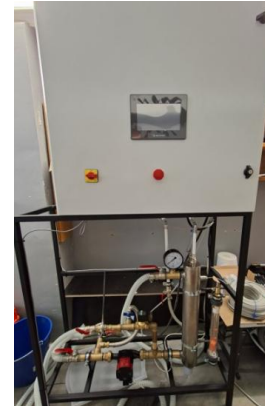
Bioreaktora statne: satur spēka vadības bloku un ūdens/gaisa komunikācijas ar kontroles un mērinstrumentiem
