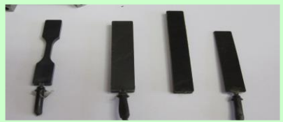
Kompozītparaugu mehāniskās testēšanas rezultāti spiedē un liecē
