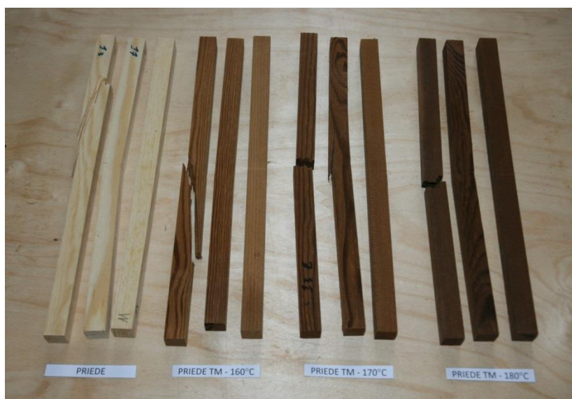
5.attēls. Nemodificēti un modificēti bērza paraugi pēc lieces testa.
