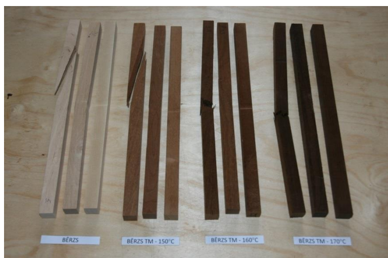
2.attēls. . Nemodificēti un modificēti bērza paraugi pēc lieces stiprības testa.
