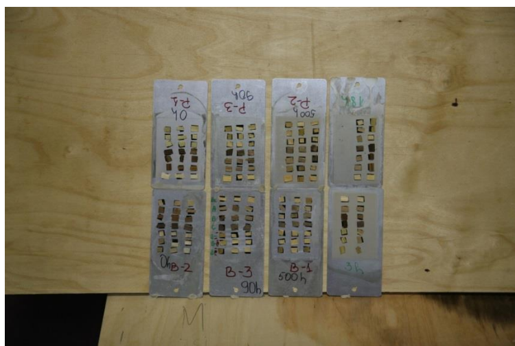
7.attēls. Nemodificēti un modificēti bērza un priedes paraugi FTIR-ATR spektriem.
