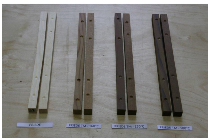
4.attēls. Nemodificēti un modificēti bērza paraugi pēc cietības testa.
