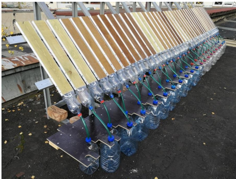
1.attēls. Paraugu stends izskalošanās un koksnes novecošanās izpētei.
